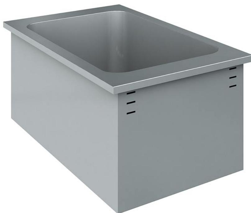
Brasiera elettrica da incasso, dotata di sistema di riscaldamento con resistenze posizionate sotto la vasca, struttura realizzata in acciaio inox AISI 304, vasca estraibile in acciaio inox di elevato spessore con spigoli arrotondati. Impostazione della temperatura da 50°C a 320°C tramite regolatore di energia, limitatore di surriscaldamento.
